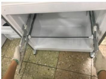
4. Con un destornillador, retire los 4 tornillos que sujetan la cubierta del canal de flujo de aire.
