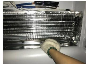
7. Lentamente, retire el evaporador del compartimento, para NO interferir con las conexiones del cableado.
