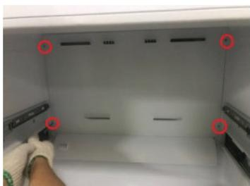
5. Desenchufe el terminal, como se muestra, y luego retire la cubierta del canal.
