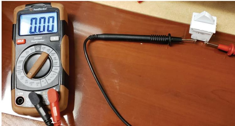
5. Reemplace el interruptor de la puerta si siempre permanece abierto o cerrado mientras presiona y suelta el interruptor.
