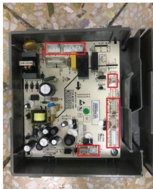
5. Con un destornillador, retire los tornillos que sujetan la placa principal a la caja de conexiones y luego retire la placa principal.
