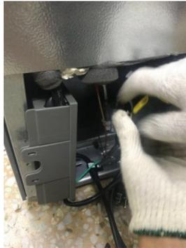
3. Con un destornillador, quite los dos tornillos que sujetan la tapa de la caja de conexiones a la carcasa.
