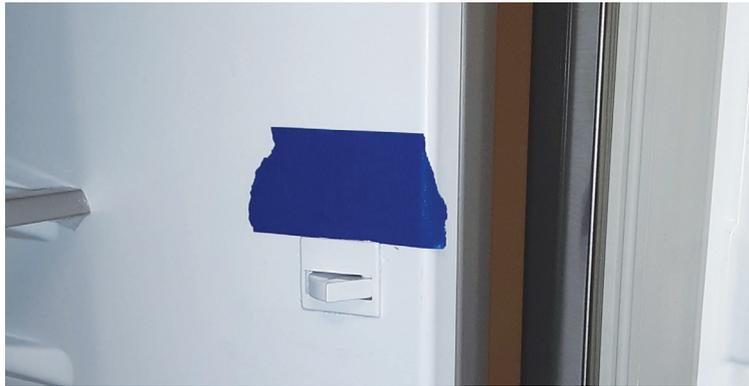
2. Inserte la punta de un destornillador de cabeza plana en el borde superior del interruptor y luego haga palanca hacia abajo y hacia afuera para quitar el interruptor de la puerta.
