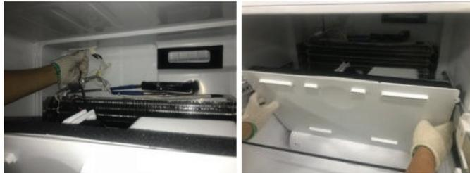
6. Retire la cinta alrededor del canal de flujo de aire, abra los clips y luego separe las dos partes del canal de flujo de aire.
