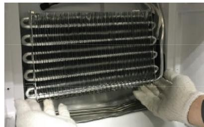
8. Retire los fusibles y el sensor del evaporador.
