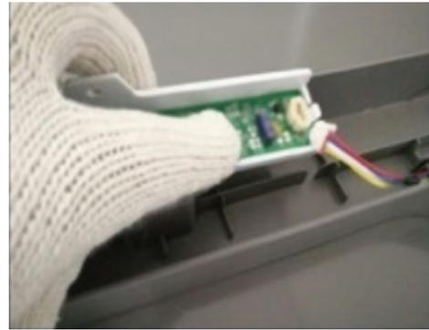
6. Retire los dos tornillos que sujetan la placa eléctrica al frente de la pantalla electrónica.
