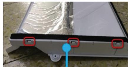
8. Con un destornillador Phillips, retire los tres tornillos que sujetan el ventilador y luego retire los motores del ventilador.
