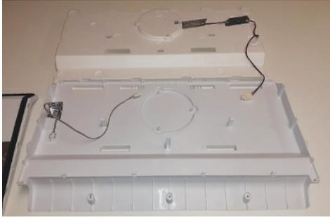
**Retire el motor del ventilador del condensador y el tubo de drenaje de descongelación**
