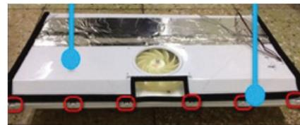
6. Extraiga el componente del canal de viento del congelador de su compartimento, como se muestra.
